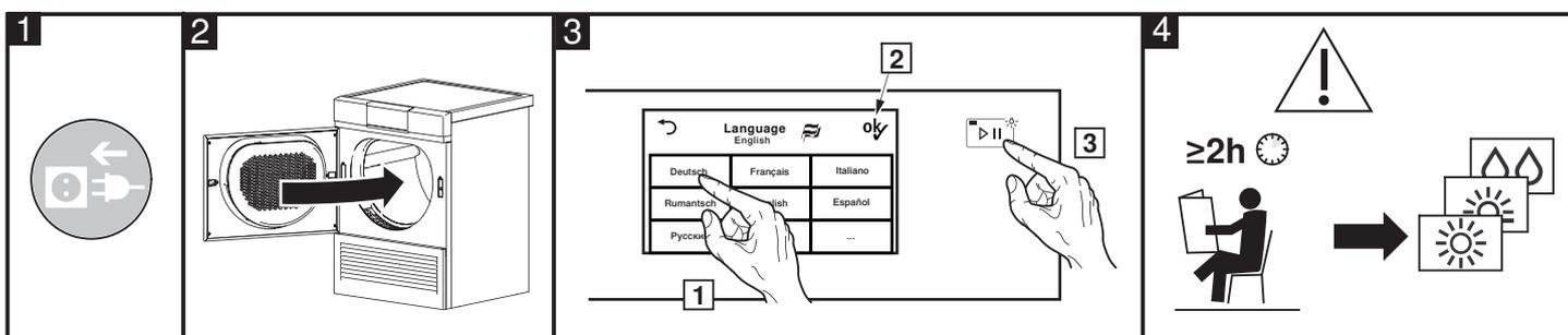
**!** Nach jeder Ortsveränderung muss das Gerät aufgrund der Wärmepumpe ca. 2 Stunden in der endgültigen Position stehen, bevor es betriebsbereit ist. Nichtbeachtung kann zu Schäden am Gerät führen.
