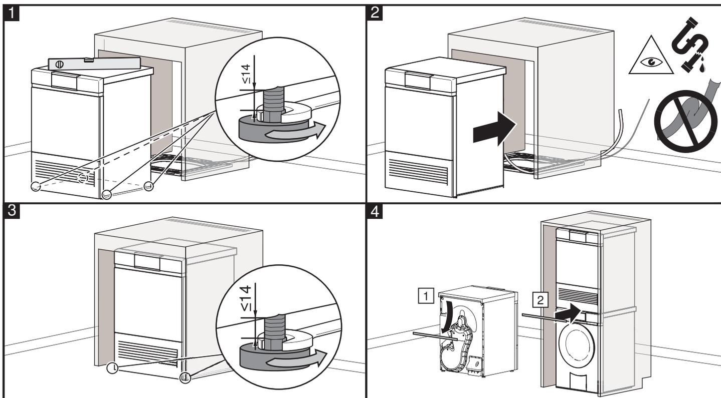
**!** Das Gerät muss lotrecht mit allen 4 Füßen fest auf der Installationsplatte stehen und darf nicht wackeln.
