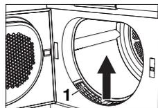
▶ Temperatursensor 2 mit einem feuchten Tuch reinigen.
