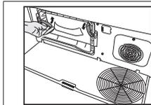
Bewegen Sie die Riegel, um den Luftleitblechdeckel zu öffnen.
