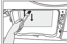
Sie können einen Staubsauger mit einer Bürste zum Reinigen verwenden. Wenn der Staubsauger keine Bürste hat, wird nicht empfohlen, ihn für die Kondensatorreinigung zu verwenden.
