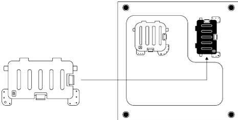
Legen Sie die Laschen von Abdeckung B gegen die untere Platte. Schließen Sie die Montage ab, indem Sie die Abdeckung drehen.
