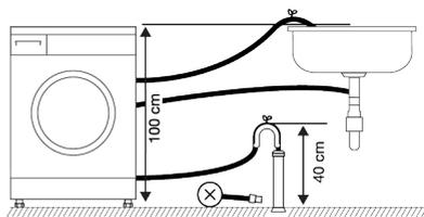
4. Damit kein verschmutztes Wasser in das Produkt zurücklaufen kann und um der Maschine das Abpumpen zu erleichtern, darf das Ende des Schlauches nur maximal 15 cm tief in den Ablauf eingeführt werden.
