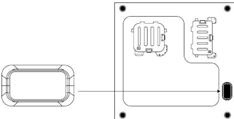
Setzen Sie die Kappe ein, indem Sie sie mit dem Finger drücken.
