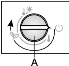
**Zum einschalten:** drehen Sie den **A**-Knopf im Uhrzeigersinn.
