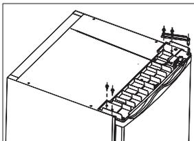
3. Heben Sie die Tür und legen Sie sie auf eine gepolsterte Oberfläche, um den Kratzer zu vermeiden. Entfernen Sie die beiden verstellbaren Füßen und nehmen Sie den unteren Scharnierbock durch Losdrehen der Schrauben. Dann übertragen Sie sie auf eine andere Seite. Hinweis: 1. Vor dem Transfer müssen Sie die Scharnierachse von dem Loch ① zu ② bewegen.
