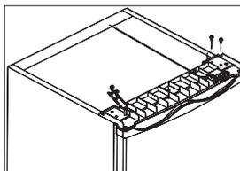
5. Stellen Sie die obere Abdeckung in den Gefrierschrank. Ziehen Sie die zwei Schrauben auf der Rückseite der oberen Abdeckung fest.
