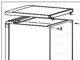
2. Entfernen Sie die vier Schrauben wie folgt. Heben Sie den oberen Scharnierkern, und dann legen Sie ihn an einem sicheren Ort.
