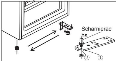
4. Stellen Sie die Tür in seine neue Stelle und stellen Sie sicher, dass der Stift in die Buchse am unteren Rahmenteil geleitet ist. Ersetzen Sie den Deckel durch Einbau des Scharnierkerns in das obere Türloch, und dann befestigen Sie ihn mit 2 Schrauben. Ersetzen Sie weitere 2 Schrauben auf die andere Seite.
