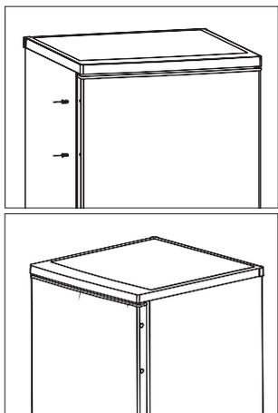
2. Passen Sie das Griffloch auf die Tür, und fixieren Sie dann die Schraube, die Sie von der Tür entfernen, um den Griff fest an der Tür zu befestigen.
