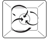
Die Garraumluft wird durch den Heizkörper hinter der Garraumrückwand aufgeheizt und gleichmässig umgewälzt. Durch die zeitlich gesteuerte Türöffnung wird die aus dem Gargut tretende Feuchtigkeit in regelmässigen Abständen grosszügig abgeführt. Das Gargut trocknet langsam aus.
