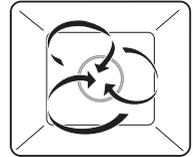
Die Garraumluft wird durch den Heizkörper hinter der Garraumrückwand aufgeheizt und gleichmässig umgewälzt.
