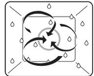
Die Garraumluft wird durch den Heizkörper hinter der Garraumrückwand aufgeheizt und gleichmässig umgewälzt. Die entstehende Eigenfeuchtigkeit wird minimal aus dem Garraum abgeführt. Die Feuchtigkeit des Garguts bleibt erhalten.
