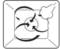
Der Garraum wird mit Heissluft beheizt. Zugegebene Dampfschwaden sorgen dafür, dass die Energie effizienter auf das Gargut übertragen wird. Der Garprozess wird dadurch leicht beschleunigt und das Gargut wird besonders knusprig.
