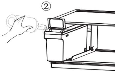
3. Montieren Sie die Wasseraufbewahrungsbox auf dem Regal des Kühlschranks
