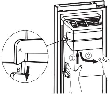
Wenn Sie ihn wieder zurücksetzen, stellen Sie sicher, dass die beiden Seiten (B & B') des Eiskübel in die Schnallen (A & A') sind.
