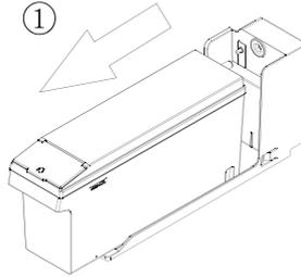
2. Heben Sie die vordere kleine Abdeckung an und gießen Sie sie direkt ein.
