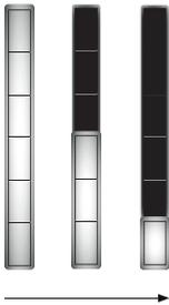
Wenn die Gerätetür geschlossen und der Startaufschub gestartet wird, leuchten alle 6 LEDs weiss gedimmt. Je weniger LEDs weiss gedimmt leuchten, desto weniger Restzeit bleibt bis zum Programmstart.
