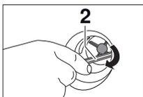
► Mithilfe des Öffners der Notentriegelung **2** kontrollieren, ob sich das Flügelrad der Ablaufpumpe drehen lässt.
