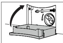
► Ablaufbehälter einsetzen und zuklappen.
