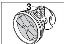
► Fremdkörperfalle mit dem pfeilartigen Führungsnocken **3** nach oben gerichtet bis zum Anschlag einschieben.
