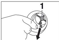
► Fremdkörper (Knöpfe, Münzen usw.) aus dem Bereich des Flügelrades **1** entfernen.
