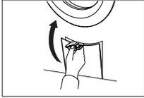
▶ Ablaufbehälter mithilfe der Klappe für Flüssigwaschmittel öffnen.
