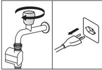
▶ Wasserhahn schliessen und Gerät vom Stromnetz trennen.
