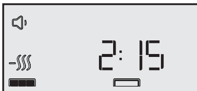
Niveau de séchage humide
