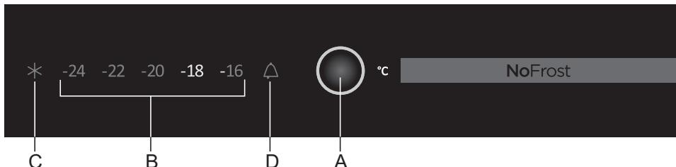
A Taste zur Temperaturstellung und zum Aktivieren der Funktion Intensivgefrieren
