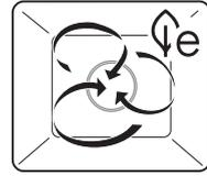
Diese Betriebsart ist besonders energiesparend. Die Garraumluft wird durch den Heizkörper hinter der Garraumrückwand aufgeheizt und gleichmässig umgewälzt. Die austretende Eigenfeuchtigkeit der Lebensmittel wird im Garraum gehalten. Das Gargut trocknet weniger aus.
