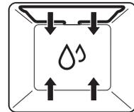
Die Beheizung erfolgt durch die oberen und unteren Heizkörper. Die austretende Eigenfeuchtigkeit der Lebensmittel wird im Garraum gehalten. Das Gargut trocknet weniger aus.
