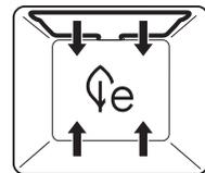
Diese Betriebsart ist besonders energiesparend. Die Beheizung erfolgt durch die oberen und unteren Heizkörper. Die austretende Eigenfeuchtigkeit der Lebensmittel wird im Garraum gehalten. Das Gargut trocknet weniger aus.
