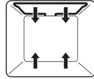
Die Beheizung erfolgt durch die oberen und unteren Heizkörper.
