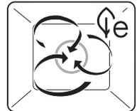
Diese Anwendung ist besonders energiesparend. Die Garraumluft wird durch den Heizkörper hinter der Garraumrückwand aufgeheizt und gleichmässig umgewälzt. Die austretende Eigenfeuchtigkeit der Lebensmittel wird im Garraum gehalten. Das Gargut trocknet weniger aus.
