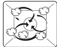
Der Garraum wird gleichzeitig mit Dampf und Heissluft beheizt. Das Gargut wird durch Dampf erhitzt bzw. gegart.
