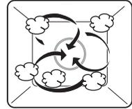
Der Garraum wird mit Dampf und Heissluft beheizt. Das Gargut wird schonend aufgewärmt und trocknet nicht aus.
