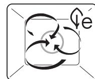
Diese Anwendung ist besonders energiesparend. Die Garraumluft wird durch den Heizkörper hinter der Garraumrückwand aufgeheizt und gleichmäßig umgewälzt. Die austretende Eigenfeuchtigkeit der Lebensmittel wird im Garraum gehalten. Das Gargut trocknet weniger aus.
