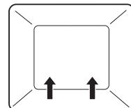
Die Beheizung erfolgt durch den unteren Heizkörper.
