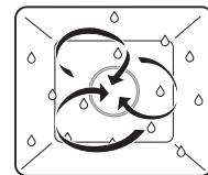
Die Garraumluft wird durch den Heizkörper hinter der Garraumrückwand aufgeheizt und gleichmäßig umgewälzt. Die entstehende Eigenfeuchtigkeit wird minimal aus dem Garraum abgeführt. Die Feuchtigkeit des Garguts bleibt erhalten.
