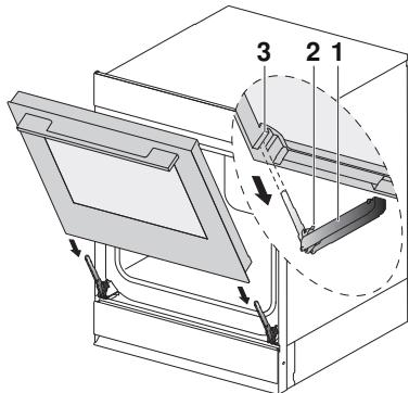
**⚠!** Sicherstellen, dass die Gerätetür bis zum Anschlag eingeschoben ist, das Gerät könnte sonst beim Schliessen beschädigt werden.
