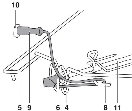
Für eine korrekte Messung der Kerntemperatur muss der dickste Teil des Fleisches bei der Markierrille im vorderen Drittel des Drehspieses platziert werden.
