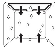
Die Beheizung erfolgt durch die oberen und unteren Heizkörper. Die entstehende Eigenfeuchtigkeit wird minimal aus dem Garraum abgeführt. Die Feuchtigkeit des Garguts bleibt erhalten.
