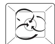
Die Garraumluft wird durch den Heizkörper hinter der Garraumrückwand aufgeheizt und gleichmäßig umgewälzt. Durch die zeitlich gesteuerte Türöffnung wird die aus dem Garraum tretende Feuchtigkeit in regelmässigen Abständen grosszügig abgeführt. Das Gargut trocknet langsam aus.
