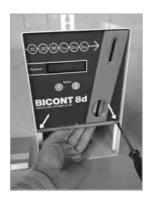
2 Lösen Sie die zwei seitlichen Schrauben am Aufsatz mit einem Kreuzschlitzschraubendreher und halten Sie die Front hierbei mit einer Hand in ihrer Position.
