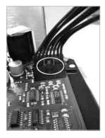
Stecken Sie das Kabel wieder in den Stecker der Elektronikeinheit und achten Sie auf die korrekte Verriegelung des Steckers.
