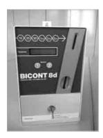
Setzen Sie die Geldkassette wieder ein und schliessen Sie mit dem Schlüssel den Gehäusedeckel.
