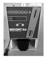
Senken Sie die Front nun um ca. 2 cm ab und ziehen Sie diese vorsichtig aus dem Gerät. Ziehen Sie das Kabel, das die Front mit der Schalteinheit verbindet, hinten an der Front aus. Achten Sie dabei darauf, dass Sie die Steckerverriegelung betätigen um den Stecker zu entfernen.
