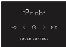
Sobald die Fleischsonde angeschlossen ist, stellen Sie das Programm und die Temperatur ein. Auf dem Display erscheint 3 Sekunden lang das Wort „Prob“. Danach wird auf dem Display die Ikone der Fleischsonde angezeigt (solange die Fleischsonde angeschlossen ist). Andere aktive Funktionen werden auf dem Display nicht angezeigt.
