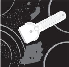
**Entfernen Sie stärkere Verunreinigungen** mit Spezialreinigern für Glaskeramikoberflächen. Beachten Sie dabei die Gebrauchsanweisung des Reinigungsmittelherstellers. **Achten Sie darauf, dass Sie nach dem Reinigen das Reinigungsmittel gründlich abwischen, weil Reinigungsmittelreste beim Erhitzen die Glaskeramikoberfläche beschädigen können.**
