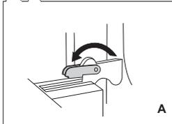
**2 A** Drehen Sie die Aushängesperre bis zum Anschlag zurück (gilt für klassisches Schließen).
