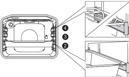
Ziehen Sie bei der Ausstattung mit Teleskop-Ausziehführungen zuerst die Führungen einer Einschubebene heraus, stellen Sie den Rost oder ein Backblech darauf und schieben Sie diese wieder bis zum Anschlag in den Garraum.
