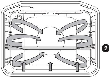
Gleichzeitig sind die Unterhitze, der Ringheizkörper und das Heißluftgebläse in Betrieb. Zum Backen von Pizzas, Apfelstrudeln und Obsttorten.
