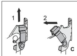
**C** Heben Sie die Aushängesperre beim GentleClose-System leicht an und ziehen Sie diese in Ihre Richtung.
