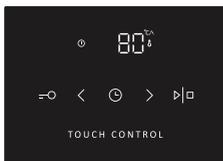
Auf dem Display blinkt die eingestellte Temperatur 80°C, die Sie mit den Tasten i < und > in einem Temperaturbereich zwischen 30°C und 99°C ändern können.
