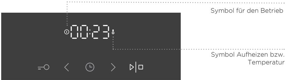
Sobald die eingestellte Temperatur erreicht ist, ertönt ein kurzes akustisches Signal, das Symbol für die Temperatur erlischt nach einer gewissen Zeit.
