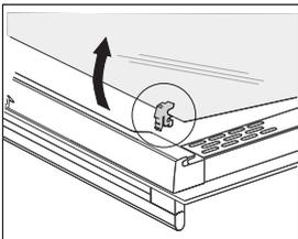
**1** Heben Sie die Träger auf der linken und rechten Seite der Backofentür leicht an (Markierung 1 auf dem Träger) und ziehen Sie sie dann von der Glasscheibe weg (Markierung 2 auf dem Träger).
