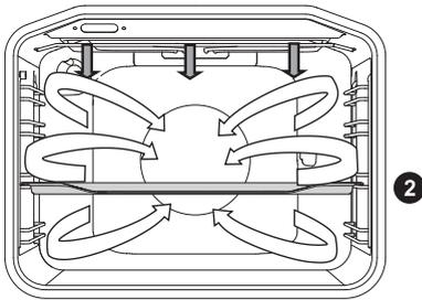
Bei dieser Beheizungsart sind gleichzeitig das Infrarot-Heizelement und das Gebläse in Betrieb. Zum Braten von Fleisch, Fisch und Gemüse.
