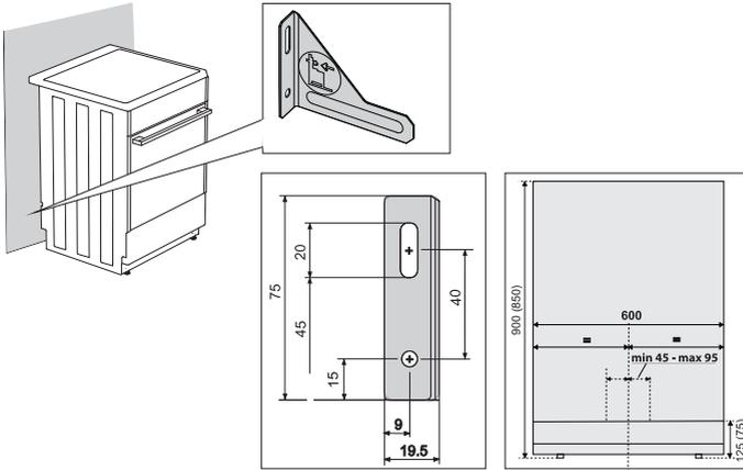
Die in Klammern angegebenen Winkel geben die Einbaumaße des Winkelstücks ohne optionales Untergestell an. Falls Sie die Kippsicherung mit den mitgelieferten Schrauben und Dübeln nicht stabil auf die Wand befestigen können, besorgen Sie sich die entsprechenden Beschläge und andere Elemente, um die Kippsicherung so zu montieren, dass sie nicht herausgezogen werden kann.
