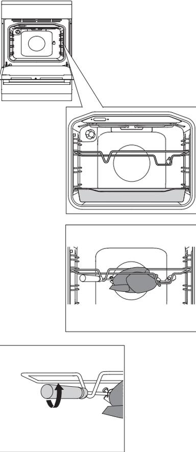
**1** Stecken Sie das Spießgestell in die 3. Führung ein und schieben Sie das hohe Backblech (Fettpfanne) in die 1. Führung von unten.
