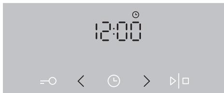
**1** Durch Berühren der Tasten < oder > kann die Tageszeit eingestellt werden; durch Berühren der Taste ☉ wird diese Einstellung bestätigt.
