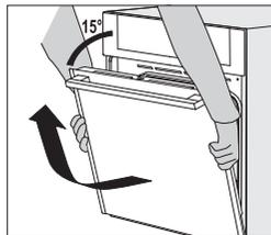
**3** Machen Sie die Gerätetür langsam zu, damit die Sperren auf den Halterungen aufsitzen. Heben Sie die Gerätetür ein wenig an und ziehen Sie sie aus beiden Scharnierhalterungen heraus.
