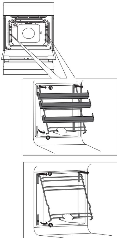
**A** Fassen Sie die Führungen an der Unterseite an und schieben Sie sie in Richtung Garraum.
