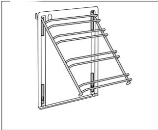
**1** Stecken Sie die Führungen auf die katalytische Auskleidung.
