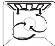
Die Beheizung erfolgt durch den Grillheizkörper. Die Garraumluft wird durch das Heissluftgebläse gleichmässig umgewälzt.
