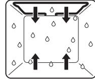
Die Beheizung erfolgt durch die oberen und unteren Heizkörper. Der entstehende Dampf wird minimal aus dem Garraum abgeführt. Die Feuchtigkeit des Garguts bleibt erhalten.
