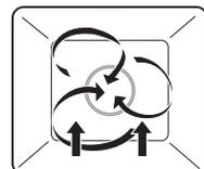
Die Beheizung erfolgt durch Heissluft und Unterhitze. Der Boden des Backguts wird intensiv gebacken.
