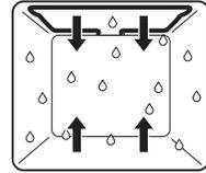
Die Beheizung erfolgt durch die oberen und unteren Heizkörper. Der entstehende Dampf wird minimal aus dem Garraum abgeführt. Die Feuchtigkeit des Garguts bleibt erhalten.
