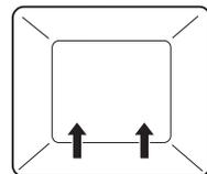
Die Beheizung erfolgt durch den unteren Heizkörper.
