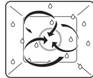
Die Garraumluft wird durch den Heizkörper hinter der Garraumrückwand aufgeheizt und gleichmässig umgewälzt. Der entstehende Dampf wird minimal aus dem Garraum abgeführt. Die Feuchtigkeit des Garguts bleibt erhalten.
