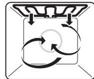
Die Beheizung erfolgt durch den Grillheizkörper. Die Garraumluft wird durch das Heissluftgebläse gleichmässig umgewälzt.
